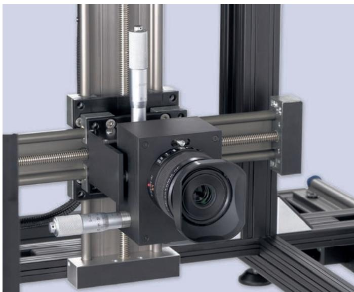
Der ForensiScan verfügt über eine hochauflösende RGB-Kamera mit einem motorisierten Objektiv. Alle Kameraparameter (Fokus, Blende, Auflösung, Verstärkung) werden digital über die Benutzersoftware eingestellt. Zur Vereinfachung der Fokuseinstellung besitzt die Software eine Autofokusfunktion und die Möglichkeit eines „Focuspeaking“.
