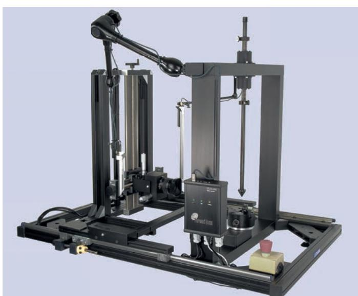
Zum Schutz gegen unbeabsichtigte Kontaminationen des Asservats mit Fremd-DNA ist der Asservatebereich mit schwarzen Aluminiumprofilen verkleidet. Zusätzlich stehen zum Schutz des Drehtellers eine leicht zu reinigende Abdeckung aus Kunststoff und für die zentrische Spannvorrichtung eine Silikonhaube zur Verfügung.
