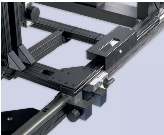
Für die korrekte Dimensionierung der Aufnahmen müssen zwei Größenparameter (Objektdurchmesser (bzw. Objektdicke) und Abstand des Objektes von der Kamera) in die Software übernommen werden. Zur Bestimmung des Objektdurchmessers steht eine elektronische Schublehre zur Verfügung, dessen Messwert automatisch in die Benutzersoftware übernommen wird. Der Objektabstand wird ebenfalls automatisch über den eingebauten Glasmessstab bestimmt.
