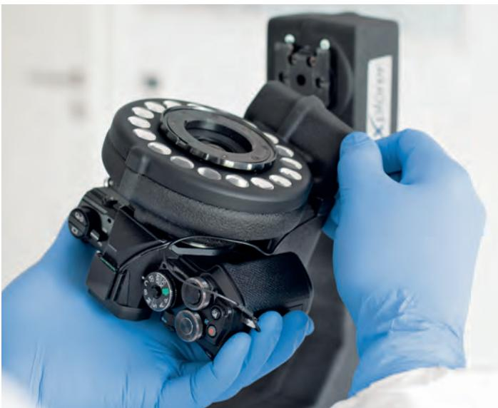
Der piXplorer 500 Mark III Forensik verfügt über ein speziell entwickeltes CX-Mount Verbindungssystem, das es dem Anwender erlaubt, die Kamera abzunehmen und für (zusätzliche) Aufnahmen von wichtigen Bereichen Ihres Tatortes zu nutzen.
