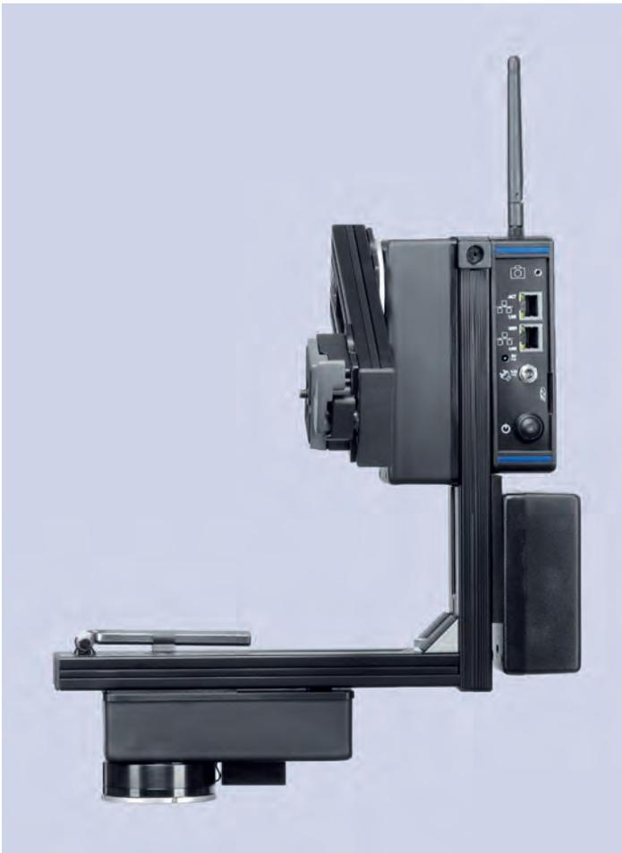
Der piXpert ist, wie der piXplorer, ein frei programmierbarer Panoramaroboter, der Ihnen alle Freiheitsgrade zur Erstellung exzellenter Panoramaaufnahmen gibt. Der piXpert ist mit allen gängigen DSLR und Mittelformatkameras bestückbar und kann durch sein hohes Drehmoment auch schwere Objektive sicher bewegen und mit höchster Genauigkeit positionieren.
