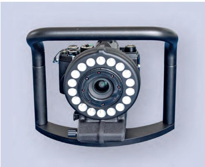
Ein eigens entwickelter Kamerahaltebügel mit integriertem Auslöser vereinfacht die Erstellung von SFM-Aufnahmeserien. Durch einfaches Umschalten des Aufnahmeprogramms stellen Sie die passenden Aufnahmeparameter ein und können im Schnellschussmodus die wesentlichen Bereiche Ihres Tatortes dreidimensional erfassen.
