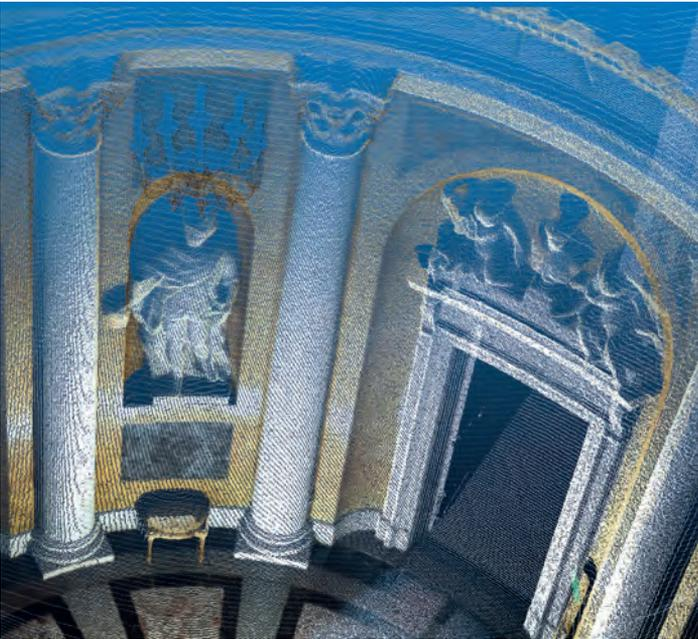
Sowohl mit dem piXplorer als auch mit dem piXplorer 500 erzeugen Sie einfach und schnell perfekt ausgeleuchtete und hochaufgelöste 360°-Aufnahmen. Diese Aufnahmen können direkt zur Einfärbung von Laserpunktewolken genutzt werden.
