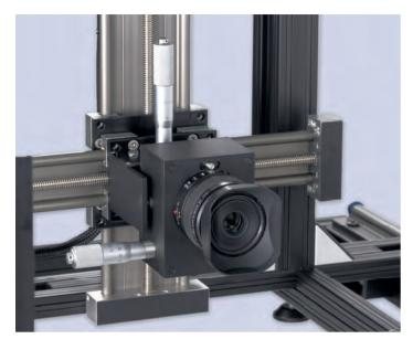
Der ForensiScan verfügt über eine hochauflösende RGB-Kamera mit einem motorisiertes Objektiv. Alle Kameraparameter (Fokus, Blende, Auflösung, Verstärkung) werden digital über die Benutzersoftware eingestellt. Zur Vereinfachung der Fokuseinstellung besitzt die Software eine Autofokusfunktion und die Möglichkeit eines "Focuspeaking".
