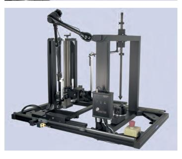
Zum Schutz gegen unbeabsichtigte Kontaminationen des Asservats mit Fremd-DNA ist der Asservatebereich mit schwarzen Aluminiumprofilen verkleidet. Zusätzlich stehen zum Schutz des Drehtellers eine leicht zu reinigende Abdeckung aus Kunststoff und für die zentrische Spannvorrichtung eine Silikonhaube zur Verfügung.
